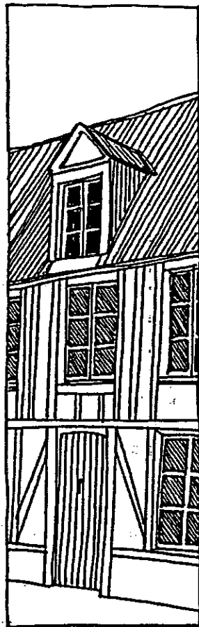
LUCARNE EN BÂTIÈRE
